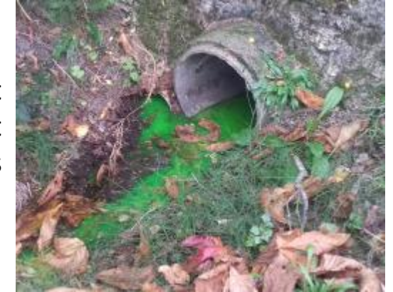
Rejet direct dans le milieu naturel d'eaux usées par un test d'écoulement avec colorant (danger pour la santé des personnes et pollution)
